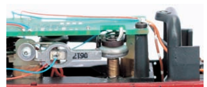
Piëzo-motor: aandrijving voor de kleinste onderdelen.
