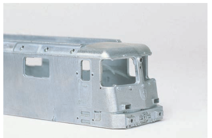
De bovenbouw van het model van de Zwitserse e-loc type Re 4/4 heeft 39 boringen. De kleinste heeft een diameter van 0,55 mm, de grootste 1,3 mm.
