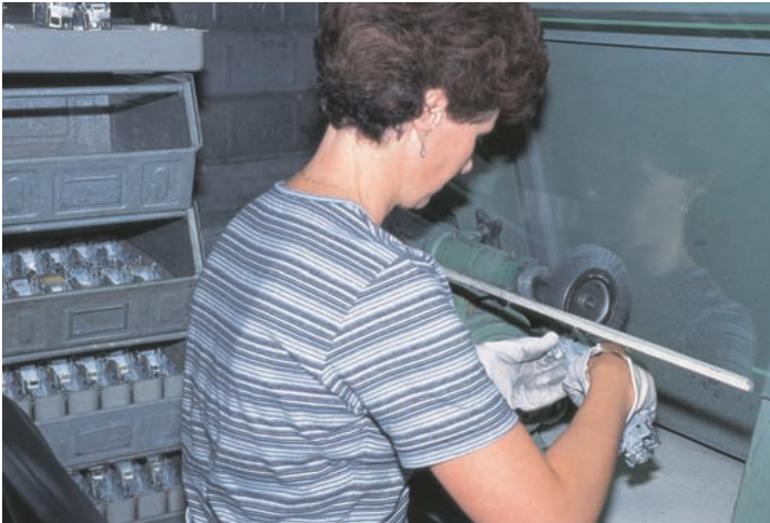
Hier worden de bramen verwijderd.
