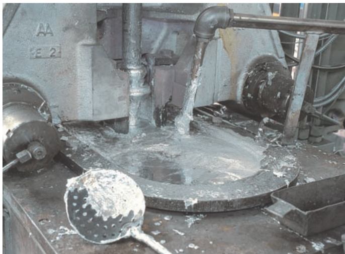
Gesmolten zink bij een zinksputgietmachine.
